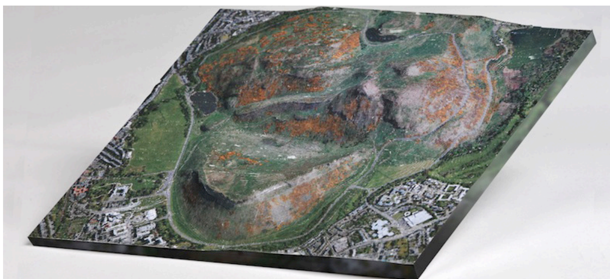
Modelos impresos con la impresora de papel MCOR 3D que permite imprimir y apilar capas de papel generando modelos tridimensionales.
